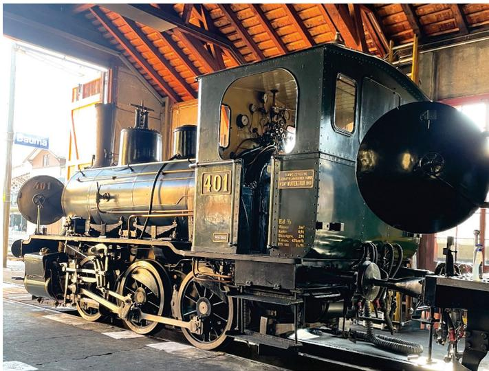
Danach erklärt uns Christian, wie so eine Dampflokomotion funktioniert. Im Kessel wird Wasser erhitzt, damit Dampf entsteht. Der Druck des Dampfes setzt einen Kolben in Bewegung, der mit einem Antriebsrad verbunden ist. Die andauernde Hin-und-her-Bewegung des Kolbens treibt das Rad an.
